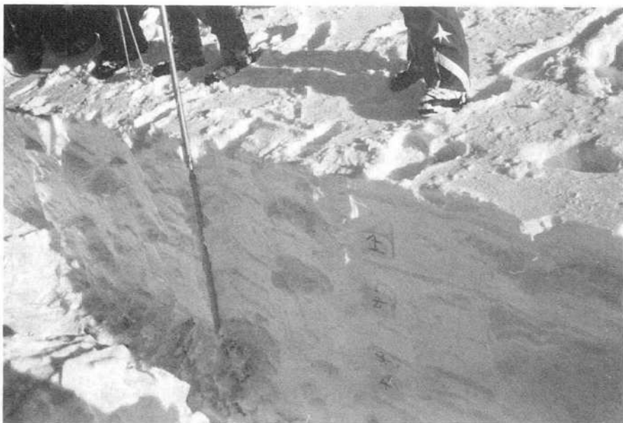
Sondas per prender emprovas da neiv e controllar la stabilitad dallas rasadas
