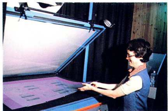
Las paginas montadas vegnan formadas ad ina satella platta d'alumini, la quala vegn silsuenter fermada en la maschina de stampar.
