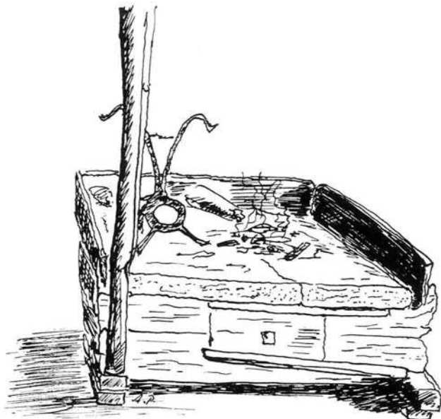
Platta chi sta aint immez chadafö, sün construezion in lain' incharna, cun chaschuot ( fuornin ) per tgnair a chod las spaisas. La pröpia platta ais da crap, a l'ur ha'la plattas stiglias missas in pè; sper il fö as vezza ün farniclet (Tirol).
