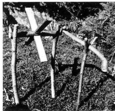
L'entira mecanica tschentada sper igl ual, cun marti ed asta che schai era en ina forscht, tenius en giugadira cun ina liunga guota. (Foto A. Maissen)
